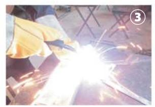
本溶接を行うポイントはあせらずゆっくりと材料を溶かし付ける。
