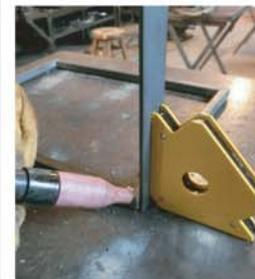
手で押えながら直角を保ち溶接することは難しいが、マグネット(写真⑤)を使用しながら行えば両手を使い簡単に溶接ができるのだ。
