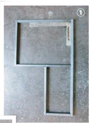
溶接するのと。溶接作業において、仮留めは重要で、精度の良し悪しはこれで決まると言っても良い。直角に繋げるときに、少し角度がずれても、仮留めであれば、修正が容易に行える。全て仮留めしたら、あとは溶接に集中し、本溶接すれば良い。
