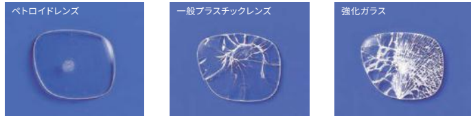
※試験条件:250gの銅球を1.3mの高さから自由落下。
