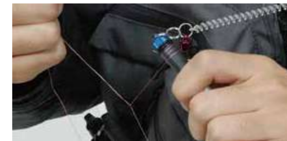
ノッター上部に搭載したゴムでしっかり締めこめます。
