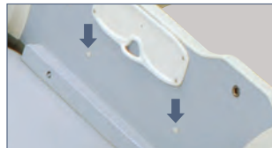
ランチングホイール 取り付け穴
