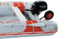
エンジンとランチングホイールの装着例
