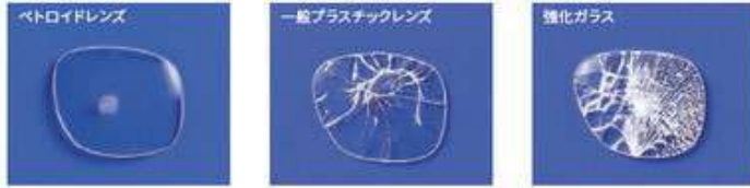
※試験条件:250gの鋼球を1.3mの高さから自由落下。
