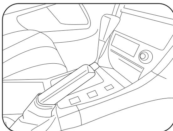
2. 純正のノブを矢印の方向に回し取り外します。
