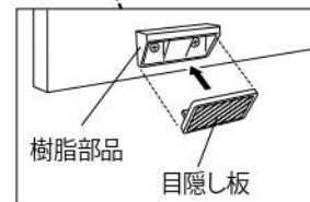
**7** 天板の底面側からネジを取り付け、目隠し板をはめ込みます(3箇所)
