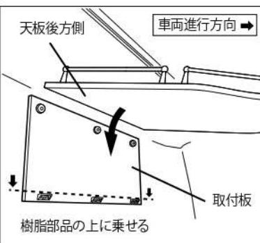
**6 2)** 天板後方側を回転させるようにして取付板の樹脂部品の上に設置します。
