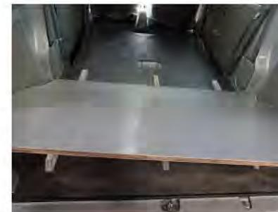
4 手順3で設置したフロアパネル前端部から5cm程度出る位置に桿木を調整します。
