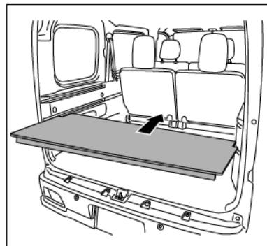
1 カーゴトレイを荷室側面の段差上面に乗せ、車両前方側へスライドさせます。
