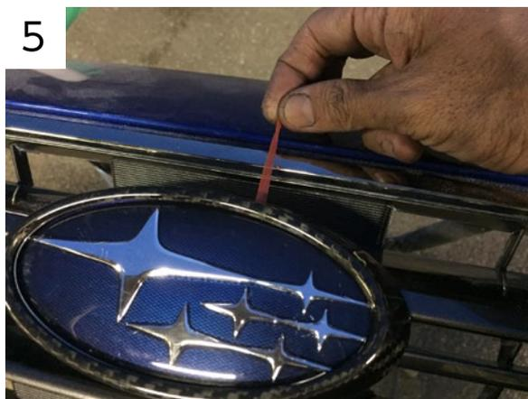
②剥離フィルムがパネルの外に出ているのを確認しながら取り付けしてください
