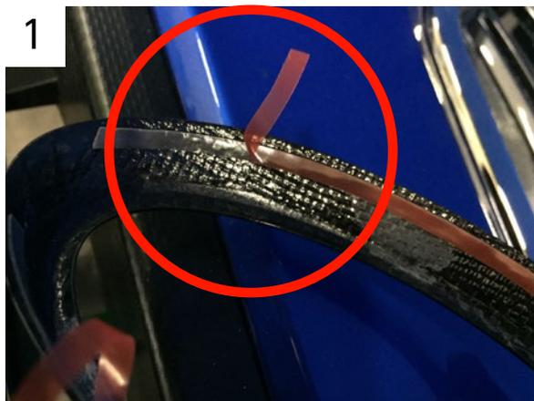
両面テープ剥離フィルムを写真の位置まで剥がし、外側へ折り曲げてください
