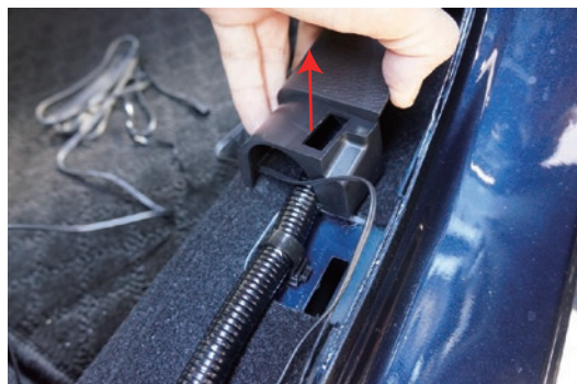
矢印の方向に持ち上げながら配線を B ピラー内に収めていきます
