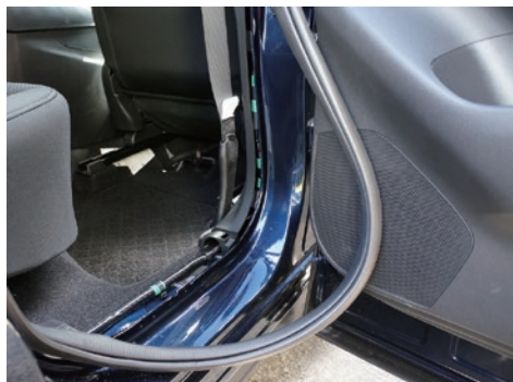
ゴムパッキンを写真のように外します
