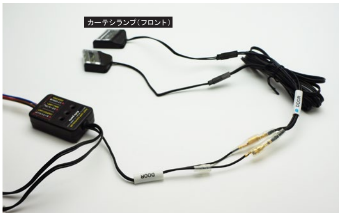
カーテシランプ（フロント）の取り付けイメージ
