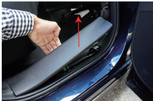
リアステップガードを手で矢印の方向に外します
