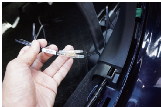
リア用延長ケーブルと DOOR 用ケーブルを接続します
