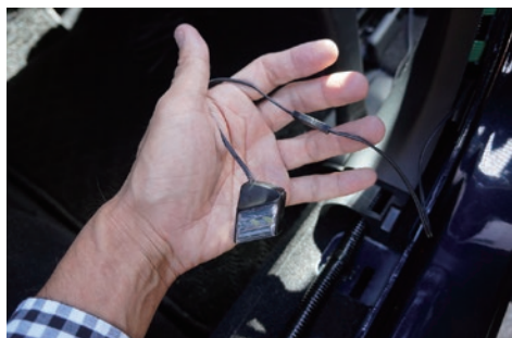
LED ランプを DOOR ケーブルに接続します
