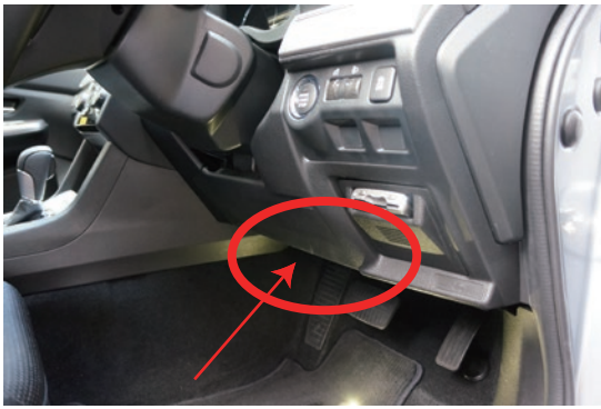
ブレーキペダルの上辺りに電源取り出し用コネクタ（15ピン / 白色コネクタ）はあります。
