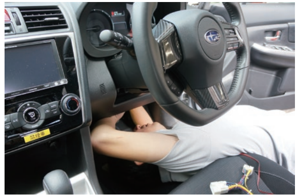
写真のような格好でコネクタを取り外します
