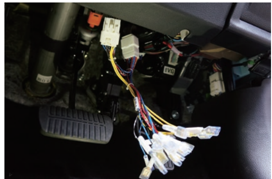
電源取り出しコネクタを取り付けます。コネクタを挿し込む際には「カチッ」と音がするまで挿し込んで下さい。
