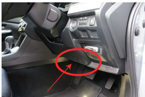
電源取り出し用コネクタ（15ピン/白色コネクタ）はブレーキペダルの上にあります。
