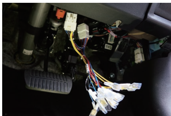
電源取り出しコネクタを取り付けます。コネクタを差し込む際には「カチッ」と音がするまで差し込んでください。
