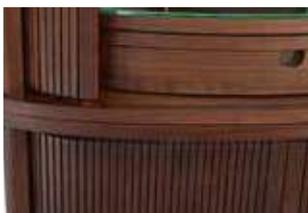
巻き戸は細い木材を組み合わせ、滑らかな曲線に合わせて変形。
