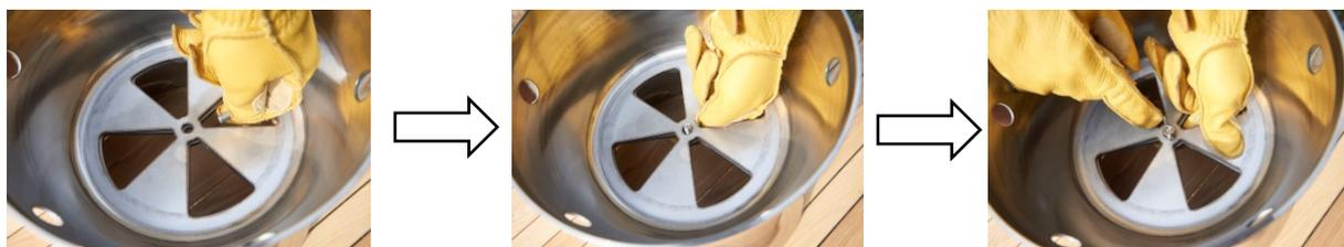
図のように、ボルトを下から中心穴に通し、上からナットで軽くしめます。きつく締めると熱膨張により本体上下の回転ができなくなる可能性があります。
