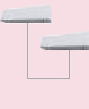
配管長50m 高落差30m チャージレス30m
