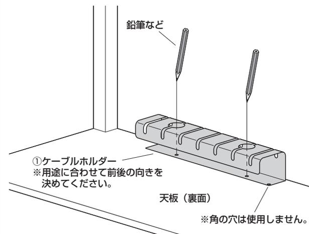
②印を付けた位置に直径2.5～2.8mm、深さ5～8mmの下穴を開けます。
