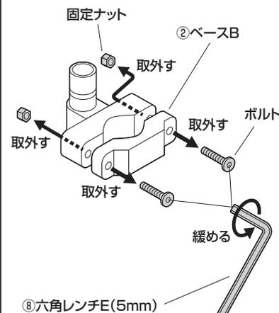
② ボルトCに交換してしっかりと締め込みます。
