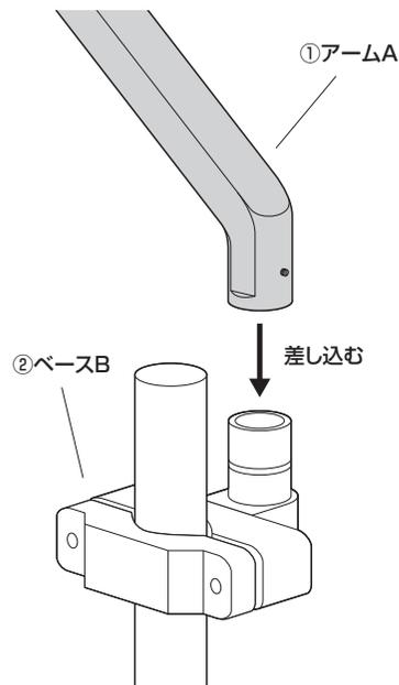
② 抜け止めネジを締めます。
