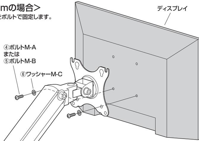
②ディスプレイの上側2ヶ所のねじ穴をボルトで固定します。
