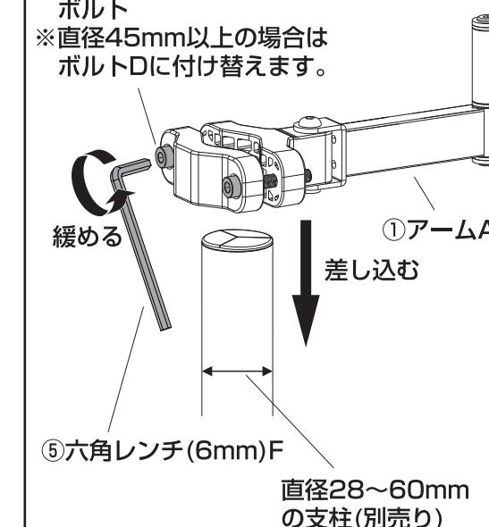
②ボルトを締め付けて固定し、ケーブルフックEを取付けます。
