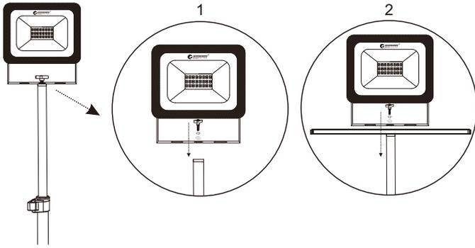
投光器のステー中央部の穴に付属のボルトを通し、ボルトを締めて確実に固定します。
