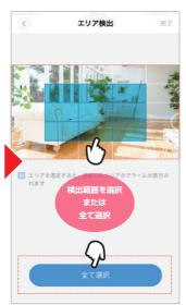
2.映像画面の中で検出エリアに設定したい 箇所のマス目をタップすると、青に変わります。 画面全てを設定したい場合は「全て選択」を タップします。
