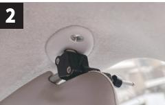
部品Aと部品Bを純正サンバイザー根元部分で挟み込みねじで締め付けて固定します。左にはL、右にはRの取り付け金具をご使用ください。
