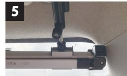
部品C・Dの上に部品Eを被せて固定します。
