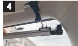
本体の巻き取りボタンがある方を右側(運転席側)にし、部品Fを、写真3で取り付けた部品C・Dと挟み込みます。
