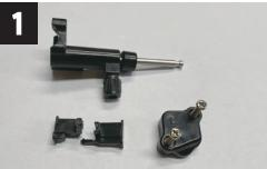
取り付け金具一式から部品A・部品C・部品Dを取り外します。部品Eが部品Fから外れないようにご注意ください。
