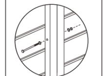
柱の連結用ボルト穴に①M6×90ボルトを通して連結します。
