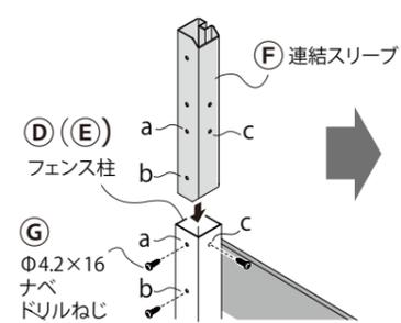
②取付けた(F)連結スリーブに上パネルの柱を差し込みます。
