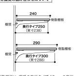
使用する樹脂棚板は、棚受の奥行タイプ-10mmの奥行サイズを お選びください。(上図参照) 樹脂樹版 P310 例) 奥行240の樹脂棚板には、奥行タイプ250の棚受をお選びください。 セット内容 棚受×左右各1本
