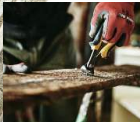
釘が刺さっていることも多い古材は、1枚ずつ丁寧に確認され、アンティークウッドとしての価値を増していきます。
