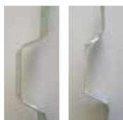
板金職人 従来品 切断材：角スパン (ガルバリウム鋼板)
