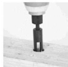
表面より10mm以内又は木材内部で折れている場合は、補助座掘錐で座掘をしてからメカアリゲーターで抜き上げます。
