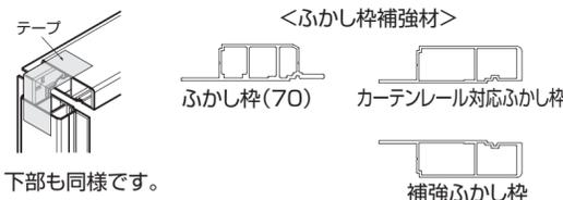
仕様により上部と下部に取付くふかし枠補強材の形状が異なります。
