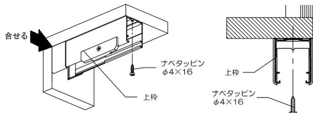
(4) 上枠インナーを上枠にセットします。
