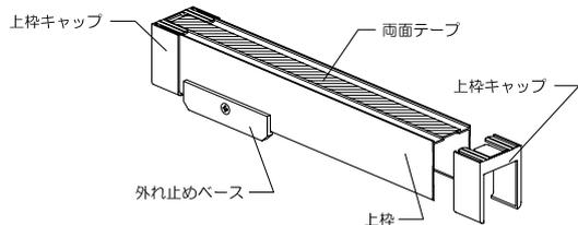
(2) 上枠の上面に付いている両面テープハクリ紙をはがします。外れ止めベースが吊元側になるようにし、木額縁の室内面と上枠キャップの室内面を合わせて仮固定してください。
