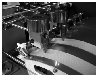
引っかかり強度 試験の様子
