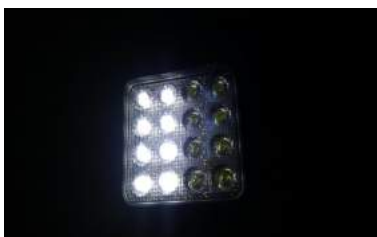
▲作業灯の点灯不良
