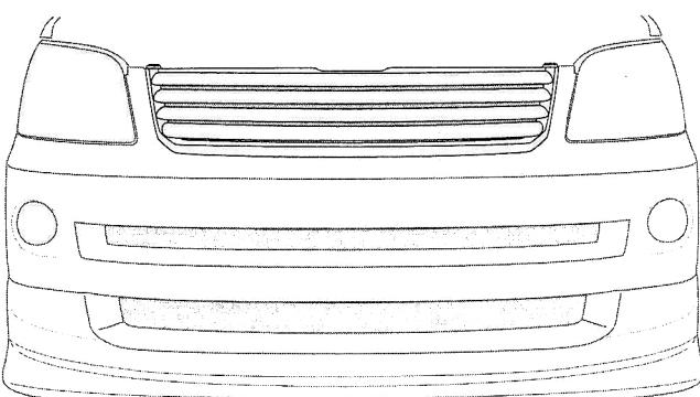
4.各部の取り付け状態が完全か確認して下さい。ボンネットを閉じて、グリルとボンネットが干渉しないことを確認して下さい。
