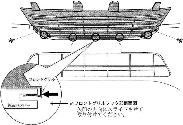
5.各部の取り付け状態が完全か確認して下さい。ボンネットを閉じて、グリルとボンネットが干渉しないことを確認して下さい。
