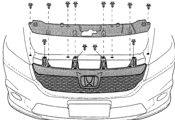
2.スクリューとクリップを外して、純正バンパーを取り外して下さい。
