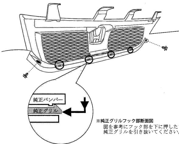
4.工程1.2.3で外したスクリューとクリップを使用して弊社グリル、及び純正バンパーを取り付けて下さい。
