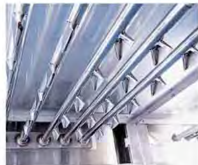
扇型に噴射する独特の高流量ノズル
