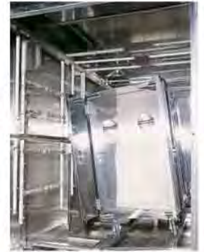
同一エリアで、洗浄・すすぎ・乾燥を、コンテナを傾斜させて効率良く行います。
