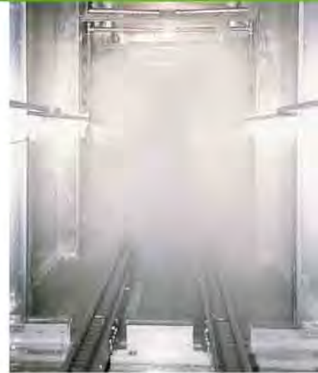
超高压の噴射で洗浄 [MDCCX]
