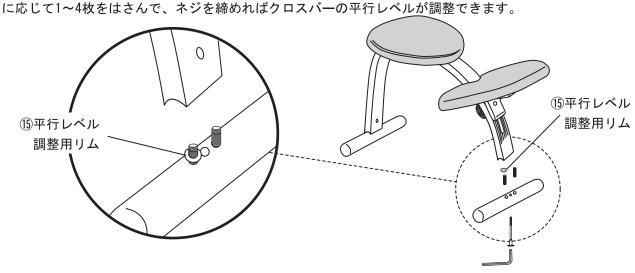
※例えば前方の右側が浮いている場合は、右側の木製ピンにリムを入れて、クロスバーを固定すれば レベルが調整できます。
