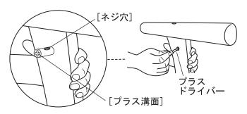
③クロスバーの下の中央の穴から⑰クロスバー固定ネジを差し込んで⑪クロスナットの穴を通して⑭六角レンチでしっかりと固定してください。
