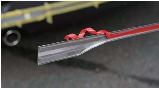
9) 両面テープの赤いフィルムは全て剥がして取り付けると失敗時にやり直しが出来ないため、写真のように両端のみ剥がします。
