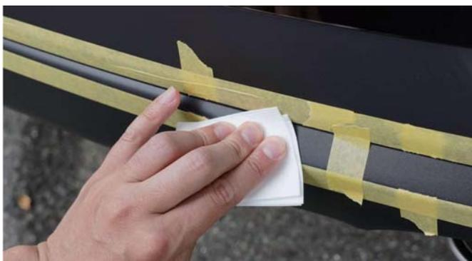
6) 1番のパーツを取り外し、脱脂クリーナーで取り付け部分の汚れ・油分を拭き取ります。
