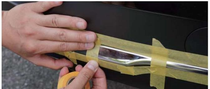
5) 1番のパーツの両端にマスキングテープを貼り付けます。取付位置の基準となりますので、ずれないように気を付けてください。
