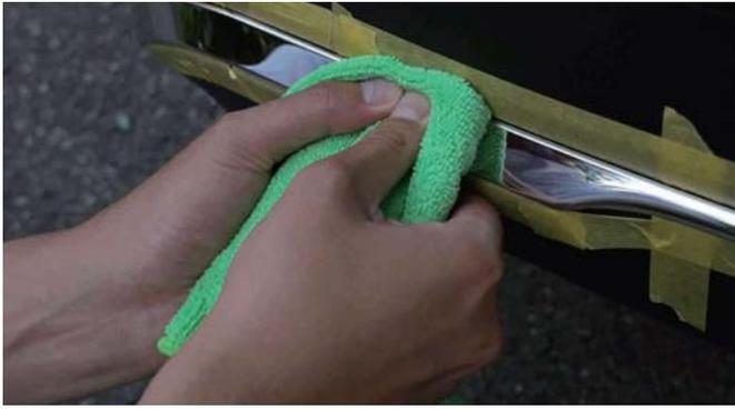
15) 取り付け終わったらパーツ全体の両面テープと車体の接地面をしっかりと押さえて圧着します。
