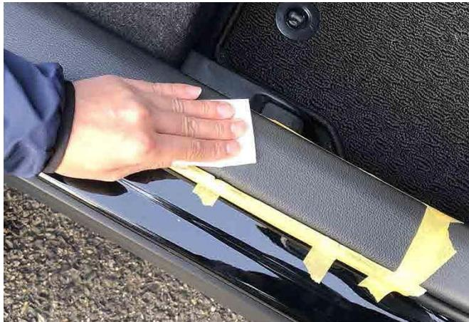
3)仮止めしたパーツを外して、付属の脱脂クリーナーを使用して装着面の脱脂を行います。
