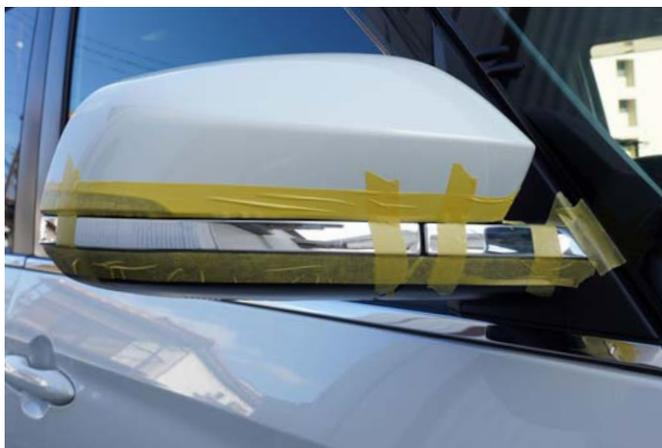
2) 付属のマスキングで商品を固定してから商品に合わせて装着箇所のマーキングと保護をします。
