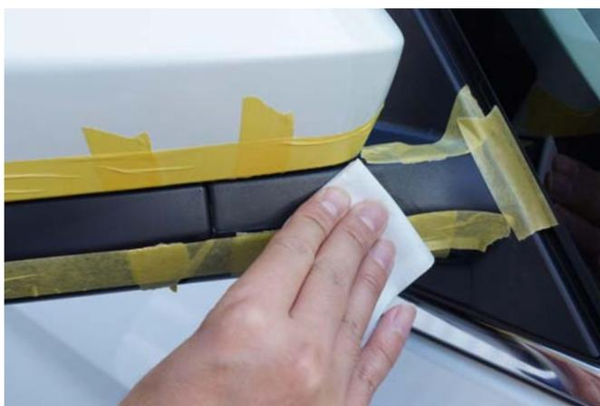
4) 付属の脱脂クリーナーを使用して装着面の脱脂を行います。
