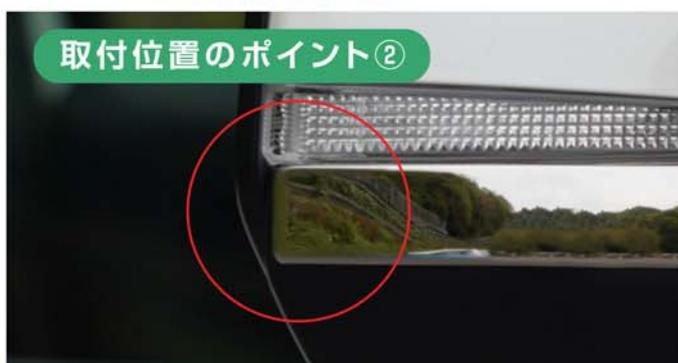
取付位置のポイント①に合わせた後に真横から見てパーツが赤丸の部分からはみ出していないかを確認してください。
