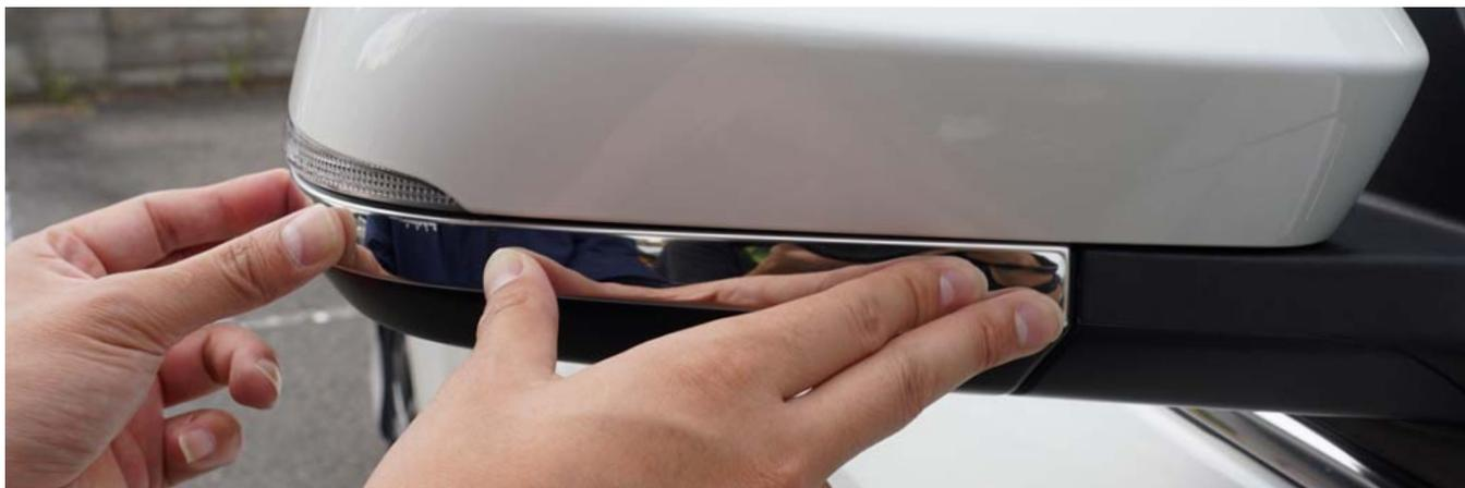
1) パーツを取り付け位置に合わせて、大きな浮き・変形がないか仮当てをして確認します。
