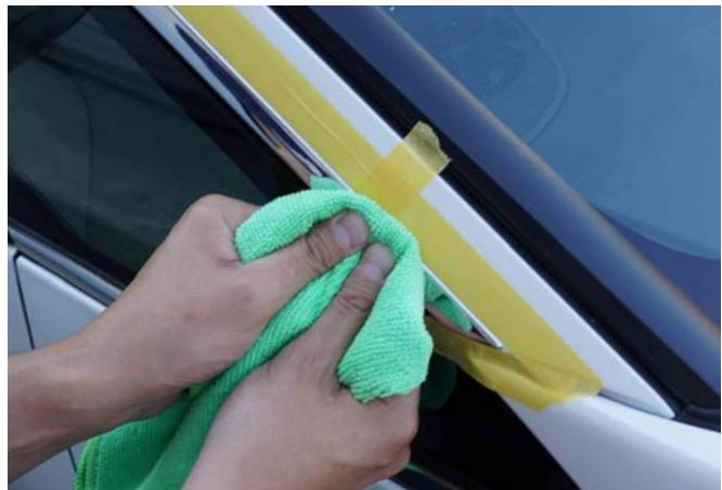
13)取り付けが終わったら圧着を行います。両面テープが当たっている場所のみを手で押さえます。薄いパーツのため、タオルを間に挟むことをおすすめします。
