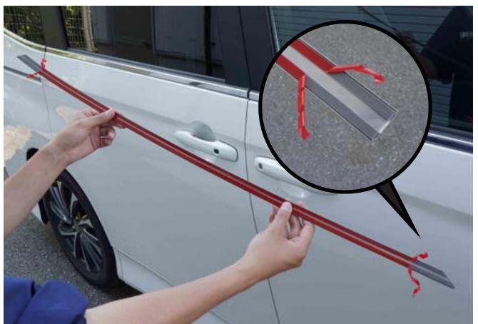
9) 両面テープの赤い保護フィルムをすべて剥がさずに、写真のように端のみ剥がして取付作業に移ります。全て剥がして取り付けた場合、ずれてしまった時のやり直しがとても難しくパーツが曲がってしまいます。
