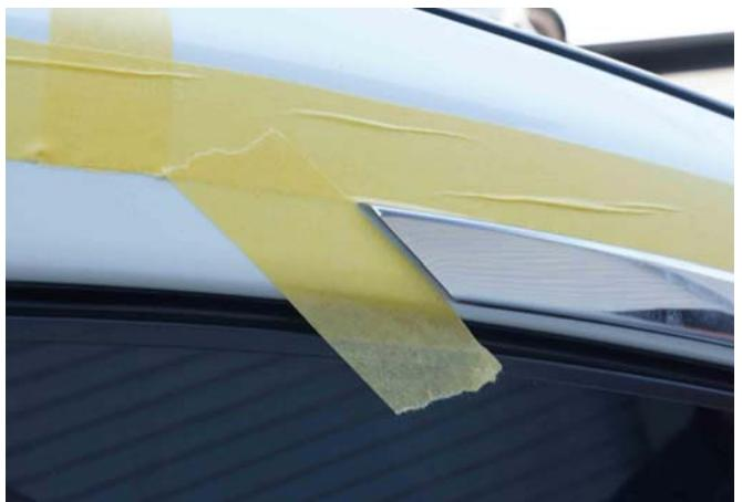
7) マーキングが終わったら最初に「2番」のパーツを外します。1番のパーツとのつなぎ目部分に合わせてマスキングテープを使って位置をマークします。貼り終わったらその他のパーツをすべて外します。
