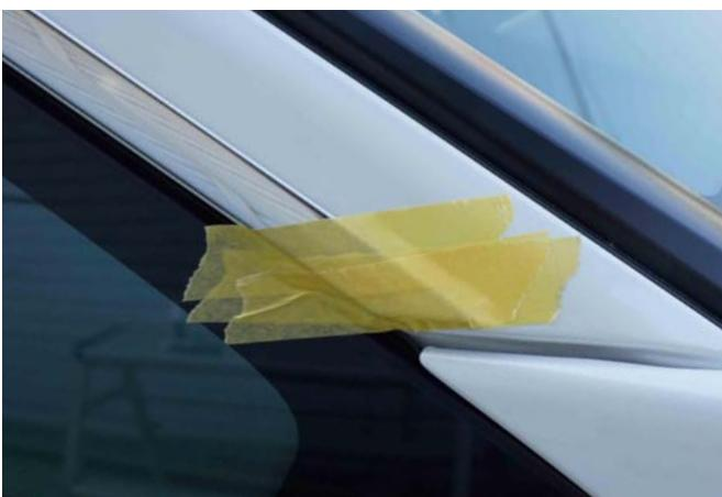
14)圧着が終わったら位置取り用のマスキングテープを全て剥がし、パーツの端や気になる場所にマスキングテープを貼り付けて固定します。この状態で車を動かさずに、約24時間両面テープと車体を馴染ませてください。
