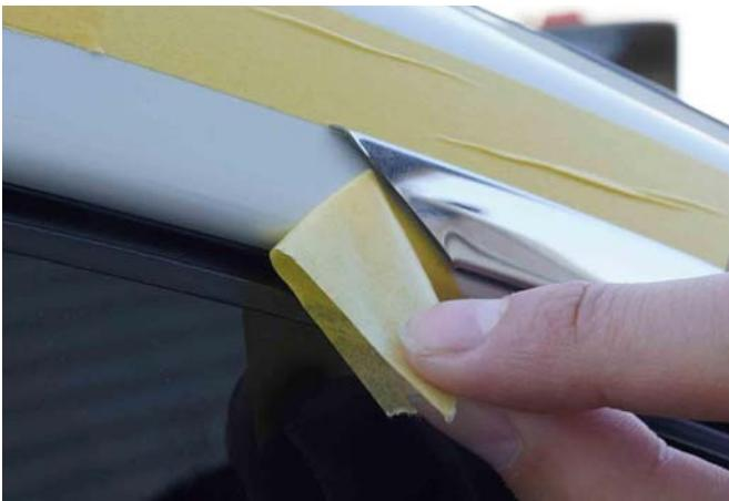
12)1番のパーツを貼り終わったら、手順7で張り付けたテープを剥がして脱脂を行います。以降は手順10～11を繰り返して他のパーツを貼り付けていきます。
