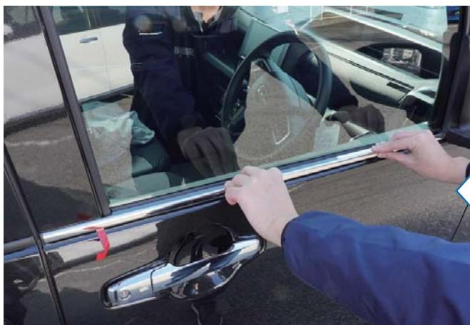
5) 位置をしっかりと確認しながら取り付けを行います。まずはパートがずれ落ちない程度に端のみ押さえます。最初に強く抑えると剥がすことができなくなりやり直しができません。
