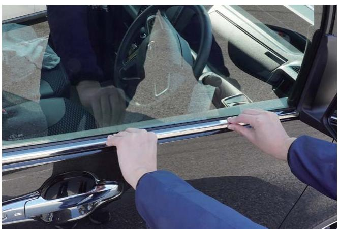
10) 固定が完了したら、パート全体の両面テープが張り付いているかをしっかりと確認します。万が一浮きがある場合は再度圧着・固定を繰り返してください。
