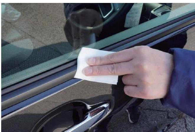
3)付属の脱脂クリーナーを使用して装着面の脱脂を行います。
