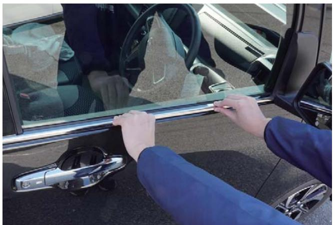
2)パーツを正しい取付位置に合わせて仮当てを行います。正しい位置に合わせてから、大きな浮き・変形が無いかを確認します
