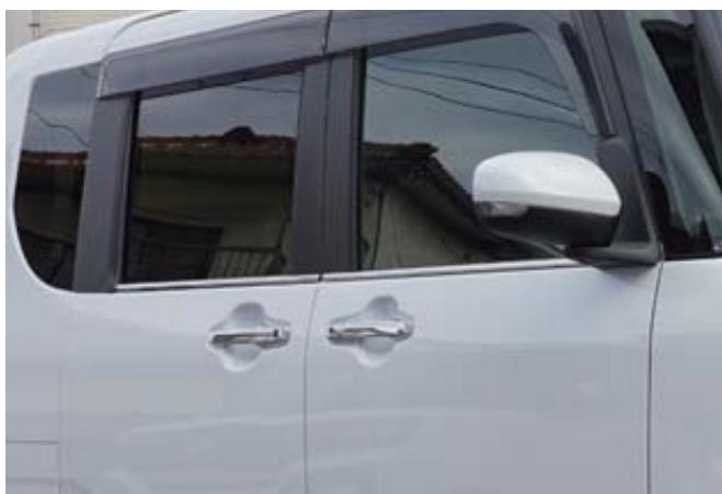
9) 取り付け後に見た目を確認し、問題がなければ両面テープが馴染むまで約半日程度車を動かさない状態で放置します。
