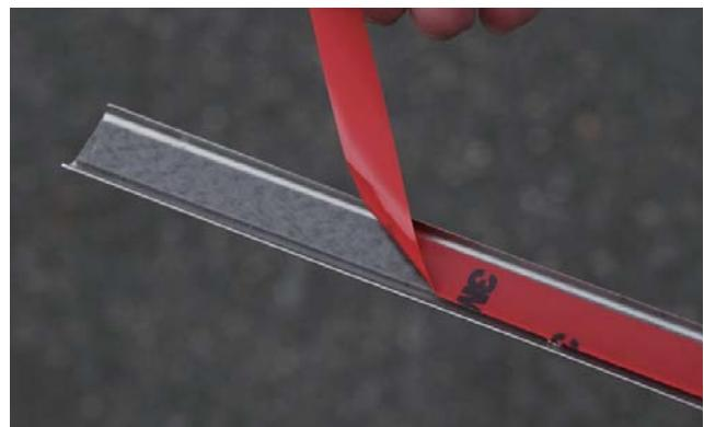
長いパートは赤い保護フィルムをすべて剥がすのではなく、写真のように端のみ剥がした状態で取付を行うことをおすすめします。
