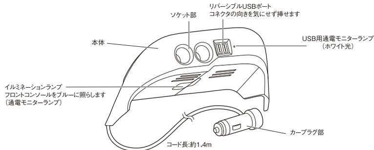
※イルミネーションランプ(通電モニターランプ)とUSB用通電モニターランプは本製品の通電確認用ですので、スマートフォン等を充電していない時でも点灯しています。
